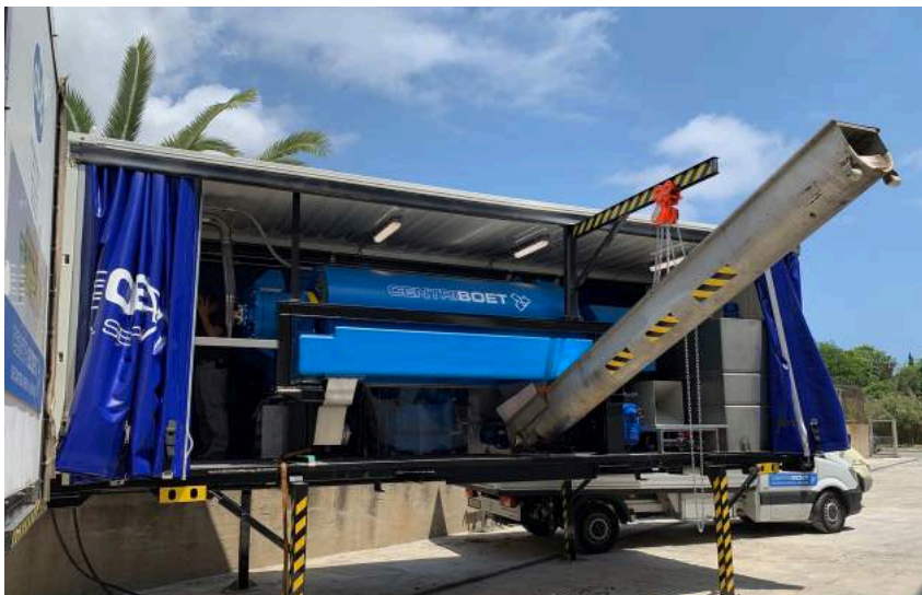
Unité mobile de centrifugation prête à être transportée vers une station d'épuration.
