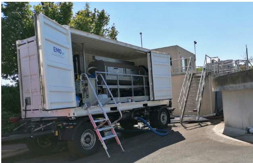
Unité mobile de déshydratation des boues EMO composée d'un conteneur sur remorque avec une presse à vis et l'ensemble de ses accessoires pour un bon fonctionnement de l'atelier des boues.
