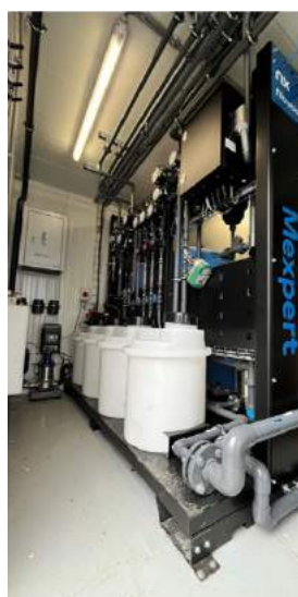
Unité pilote « mobile » Mexpert C développée par NX Filtration pour des applications de production d'eau potable & de traitement tertiaire / quaternaire des eaux usées.
