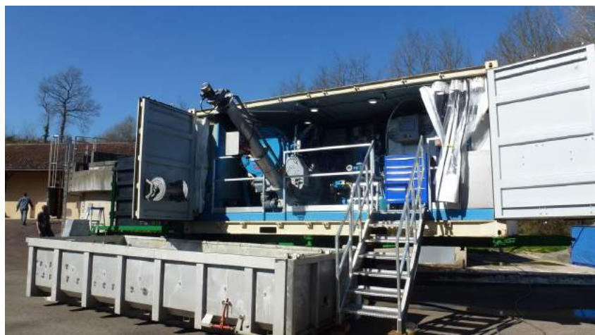
Rotary presse en container sur une step urbaine de chez Faure Equipements.
