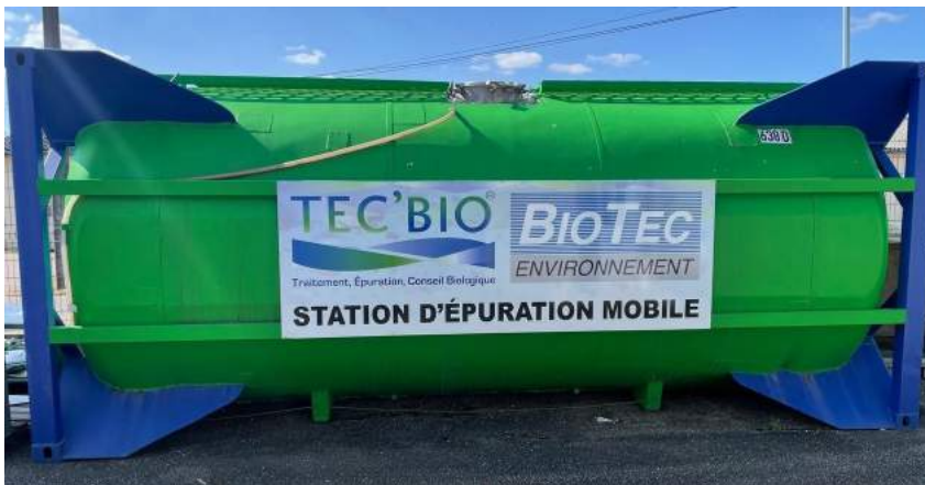
Stations d'épuration en tanks Citernes ISO 20 pieds maritimes 25 m 3 Process d'épuration biologique de type SBR et MBBR.
