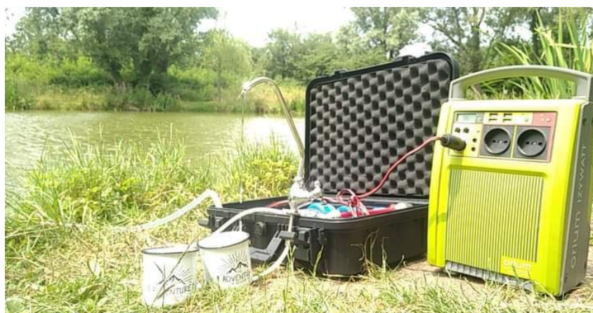
Valise autonome Alfaa composée d'une alimentation électrique, d'une pompe 12V, de différents étages de filtration en 5" (filtration des MES, charbon actifs, UF) ainsi que d'une LED UVc pour la destruction des bactéries pour un débit max. de 200l/h.
