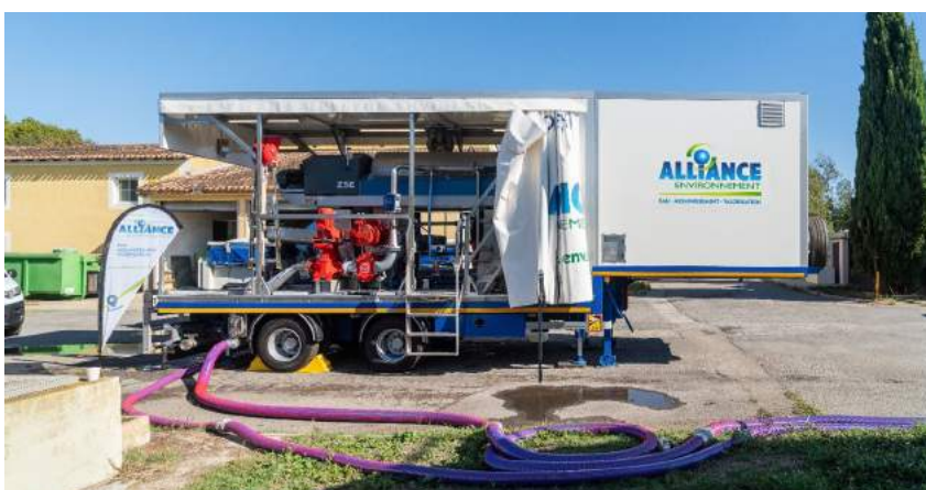
Unité mobile de déshydratation flottweg Z5 montée sur semi-remorque déployée sur une station d'épuration péri-urbaine.
