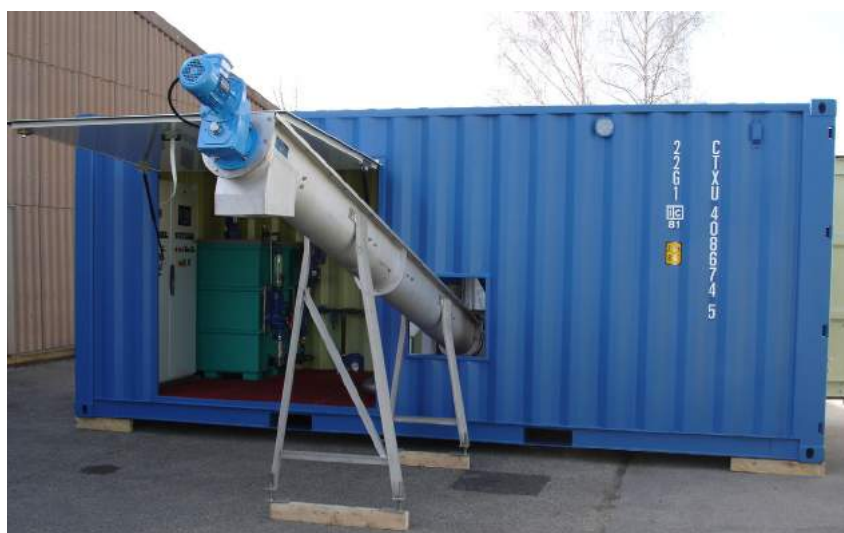
Station de traitement de boues en container : Autofloc 8710 + centrifugeuse, de chez TMI.
